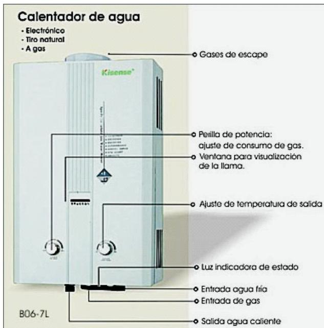
1. El sistema de encendido electrónico y la total ausencia de llama piloto, hace que la unidad no esté desperdiciando gas en mantener una flama que en caso de apagarse, puede ocasionar una fuga peligrosa. Kisense solo deja pasar el gas cuando comprueba: flujo efectivo de agua, la no existencia de residuos de gas u otros gases dentro de su sistema y la ausencia total de alta temperatura en la tubería de salida de agua caliente.
